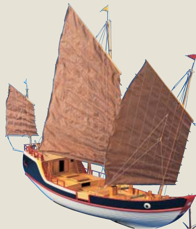
二十世紀 廈門商船模型 105×26×95公分 財團法人張榮發基金會藏 明清時期航行臺灣海峽海域的船，船身扁長，尖刀型風帆高聳，航速快。一般廈門商船的尺寸為長21公尺，寬5.1公尺，深3公尺。
