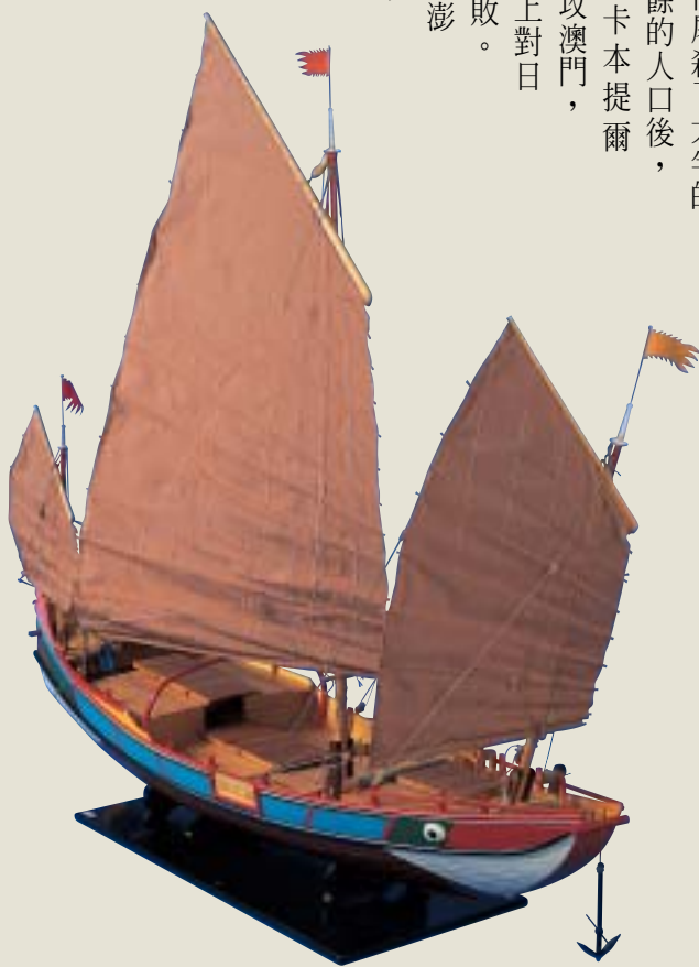
二十世紀 福州花船模型 128×28×110公分 財團法人張榮發基金會藏 福州船係明清時期福建所造，廣泛用於遠洋貿易。船底呈V字型，即所謂的尖底船，主要以松木、杉木、樟木為船材，用木樁與鐵釘結合船板。實體船可長50多公尺，主桅高30多公尺。
