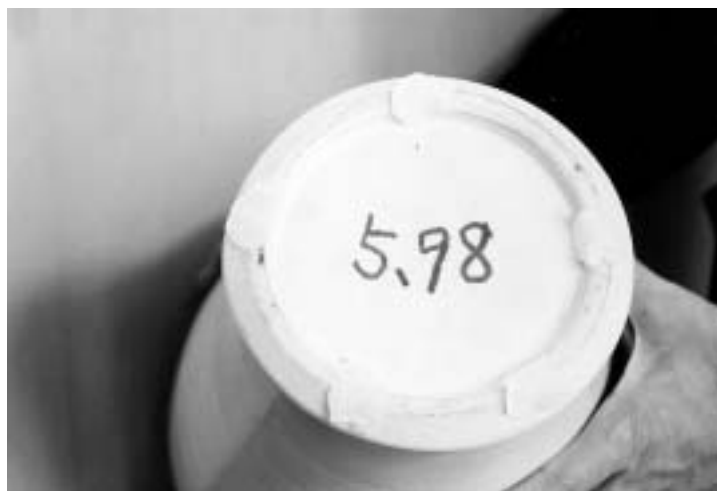
圖五 在重量為5.98公斤的中型梅瓶底部圈足，用微晶蠟蘸粘五點，亦可使瓷瓶抵擋七級烈震的侵襲而不傾倒。微晶蠟用量即使減少到0.47公克，也具有相同的功能。
