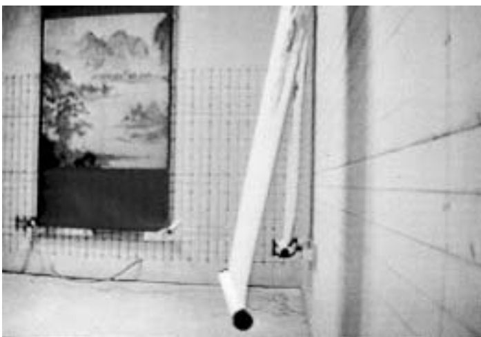
圖六 懸掛牆上的國畫立軸，若其下軸沒有托住，強震來襲時木軸會猛烈拍打牆面。
