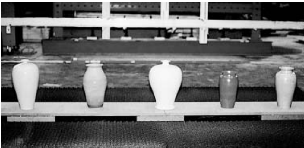
圖一三 在振動台上間隔50公分放置四台櫃內型隔震台，隔震台上再放置數塊互相扣合的長條形不銹鋼銅板，可以發揮更好的功能。
