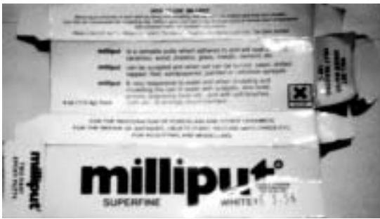
圖一 milliput 為精緻瓷器修復材料。
