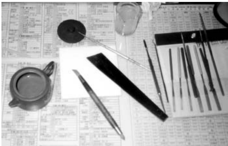
圖五 以握柄顏色分別銼刀粗細，使用方便。
