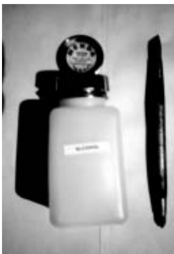
圖三 橡皮筆及左邊的壓液供液蓋瓶，為修復便捷工具。
