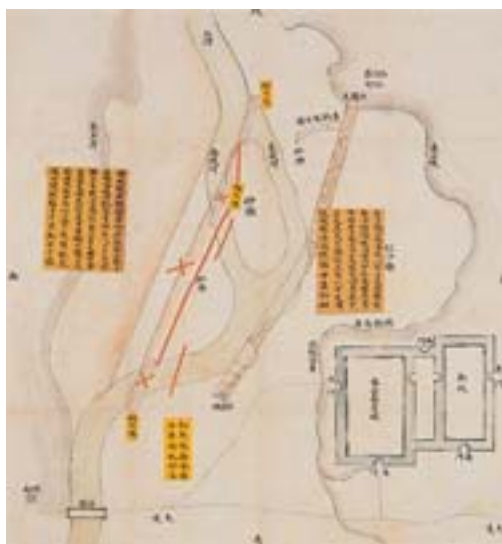
乾隆四十五年（1780），直隸總督袁守侗奏為請修築密雲縣護城石子壩工事摺，並附「密雲縣城西石子壩修砌段落並開引溝」圖。
