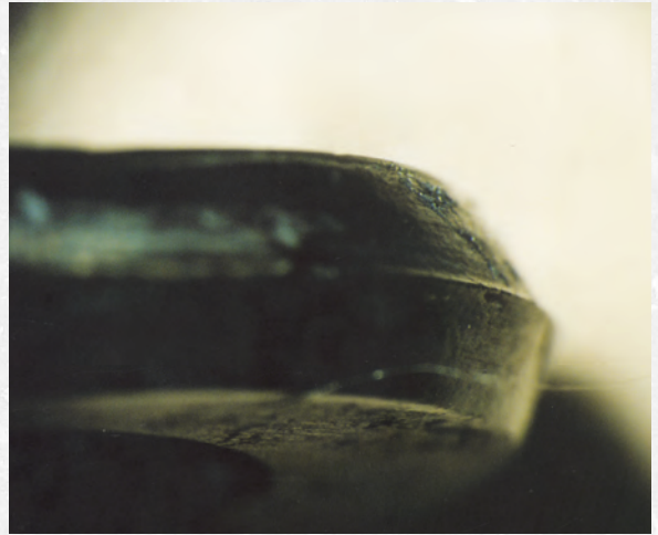
圖九-4 外緣器壁有明顯的接合線
