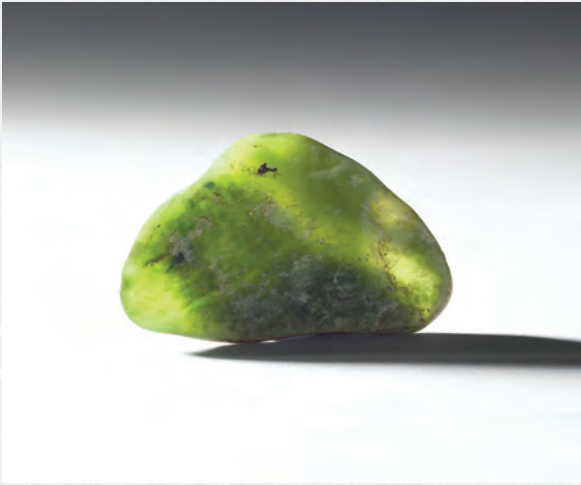
圖二-2 光線由後面照射，可看出不勻的透光性與黑色的包裹物
