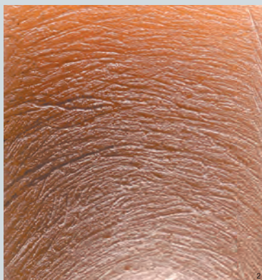
圖十一：實驗五（弧形片切割） 弧形片切割軟玉（1）及葉臘石（2），呈斷續弧線。
