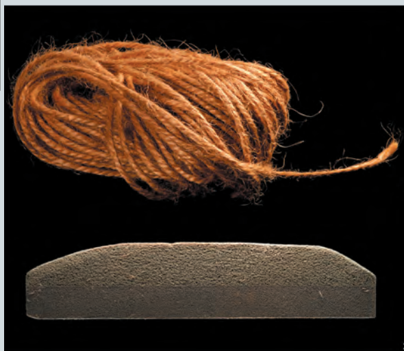
圖六：切割實驗器材 1 麻繩：單根直徑0.5公分 2 片鋸：以磨刀石製成
