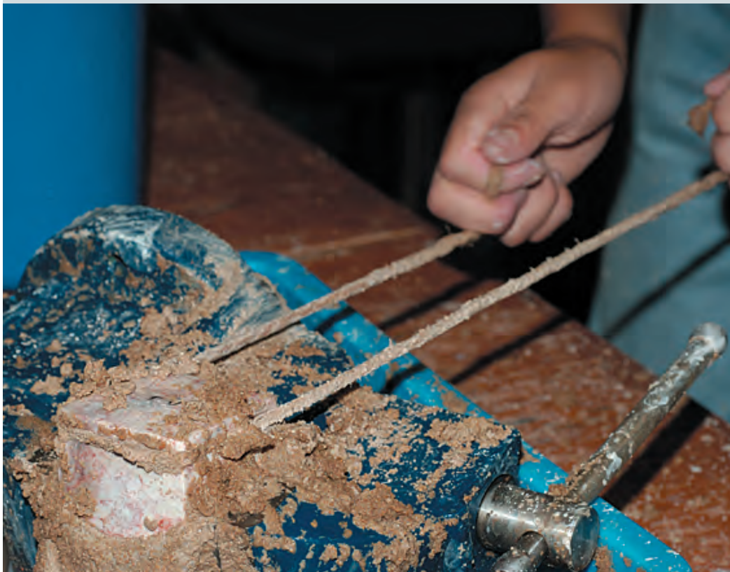
實驗三：單向線切割片解。兩手拉緊線繩，以每秒五個來回進行水平方向的切割。進行時，還要不斷加入砂漿。
