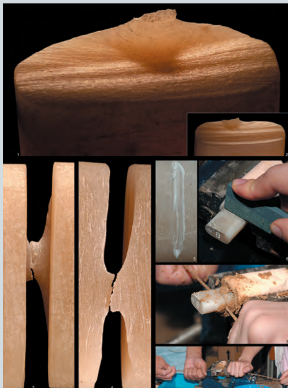
圖七：實驗一（單向線切割I） 1、2 切割面 3 平直的入切口 4 出切口 5 槽痕 6 石鋸開槽：固定麻繩的運動軌跡 7 繃直麻繩下切，以求證線切割造成非拋物線切痕痕的可能性 8 切割方法：手握濕砂敷於麻繩，往復勻速拉動
