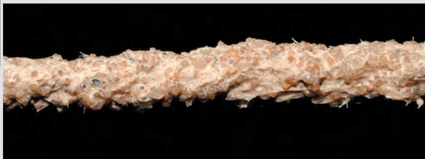
圖一：砂繩 麻繩摻砂漿後即成砂繩，倚仗砂粒鋒利刃沿切割玉石，砂繩截玉，無堅不摧。
