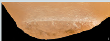
圖八：實驗二（單向線切割II） 1、2 切割面
