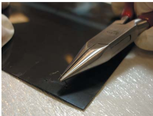
圖十六 清潔修護步驟二「移除舊釘針」
