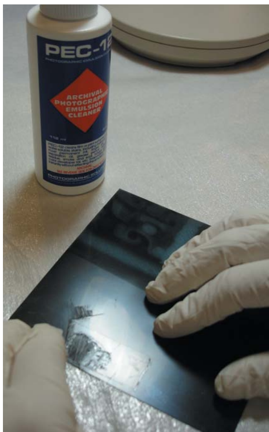
圖十八 清潔修護步驟三「擦除殘膠污漬」
