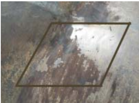
圖六（左）為進行清潔測試前的檢視窗，圖七（右）為進行清潔測試後的檢視窗，顯示風化物僅為表面堆積，並無深入腐蝕現象。
