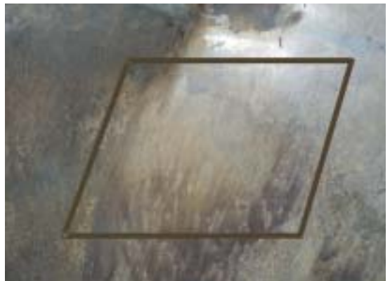
圖六（左）為進行清潔測試前的檢視窗，圖七（右）為進行清潔測試後的檢視窗，顯示風化物僅為表面堆積，並無深入腐蝕現象。
