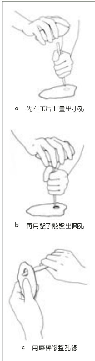
圖三三 鑿磨法工序示意圖
