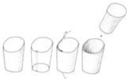
圖十四 線切割取出箍形器芯料的工序示意圖
