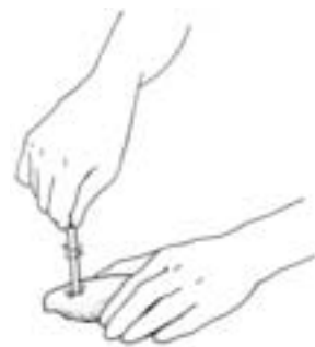
圖二六 徒手鑽孔示意圖
