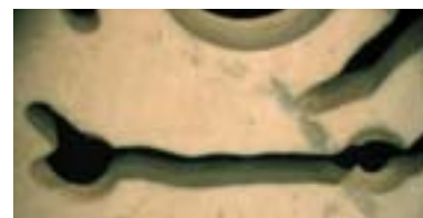
圖五八c 線切割的長條鏤孔兩邊凹凸對應
