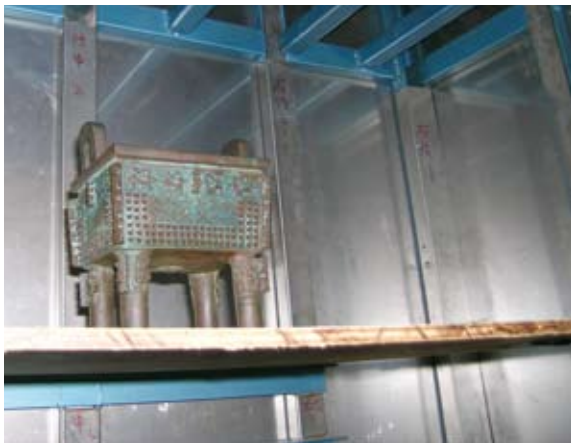
圖六 將銅器放置於X光放射攝影鉛箱中並於底部放置X光底片
