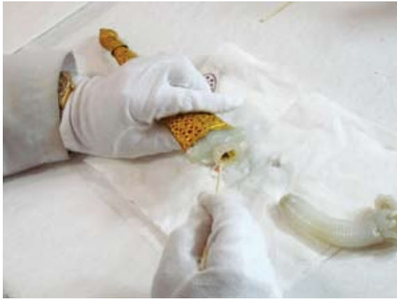
圖十 將適量的黏結劑塗佈至刀柄與刀把接合處
