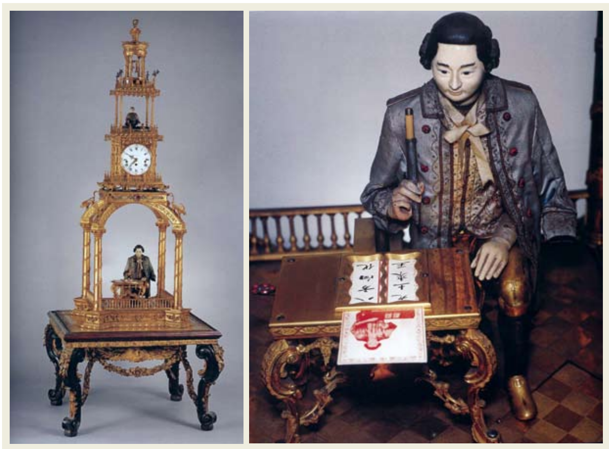
圖二、三 銅鍍金寫字人鐘，十八世紀。目前收藏於北京故宮博物院鐘表館（奉先殿）。該鐘高231公分，鐘底安置一西洋模樣的機器人。上弦後，機器人開始提筆書寫「八方向化，九土來王」，橫、豎、撇、捺都有筆鋒，足見其設計之精巧。
