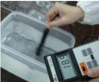
圖十三 進行泡水脫鹽療程期間，每日換水3000ml一次，量測導電度早晚各一次。
