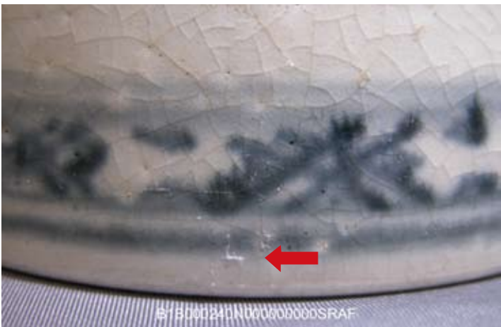
圖四 釉面縫隙生出鹽花（箭頭所指處）
