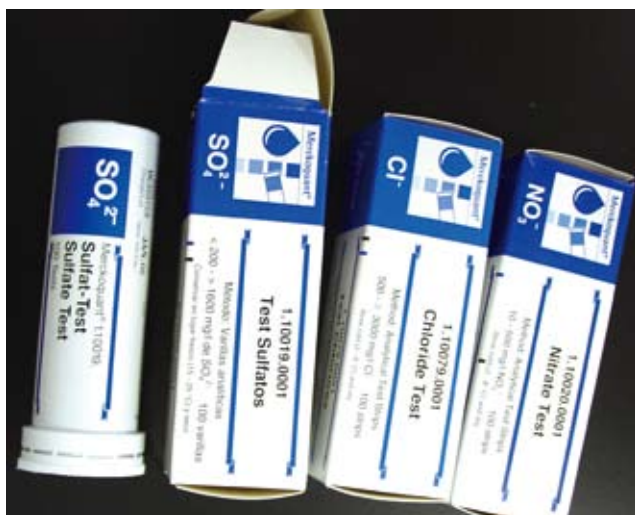
圖九 Merck試紙，可分別測試硝酸鹽類、氯化鹽類、硫酸鹽類的反應。
