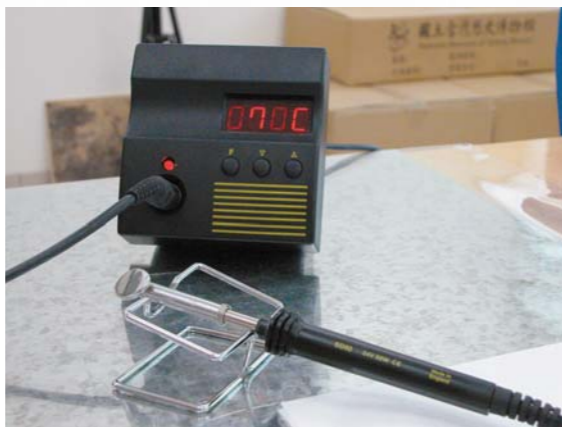
圖七 小頭的電熨斗，使用溫度為70°C。
