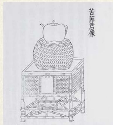
圖十九 明 顧元慶《茶譜》苦節君圖 苦節君即竹茶爐，以竹編外型，內為泥製，上圓下方。茶爐造型與圖十五丁雲鵬所畫相同。
