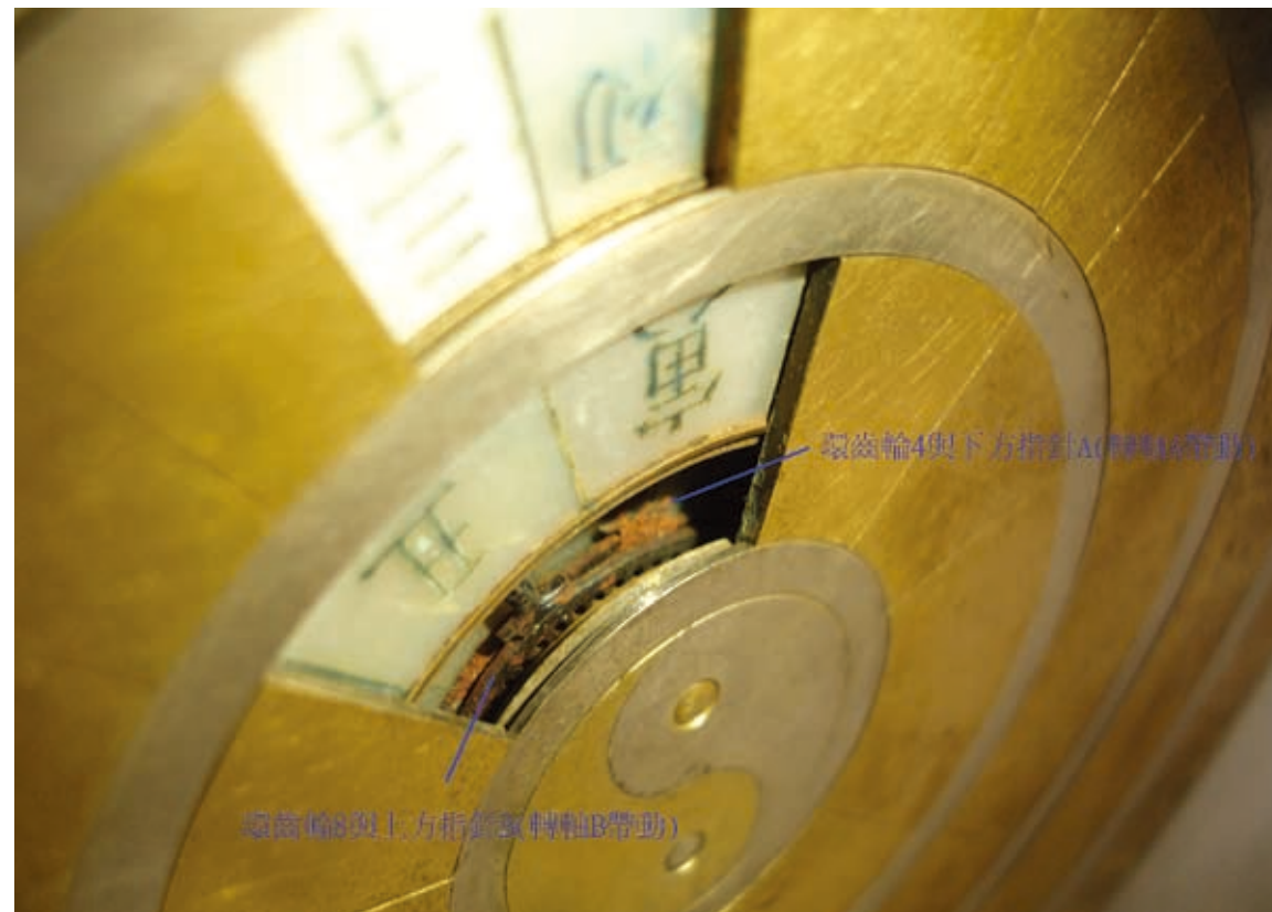
圖八 由斜射光源側拍，可約略見指針與其環齒輪結構。
