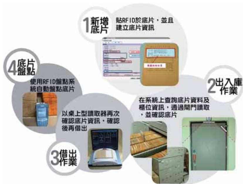
圖五 底片RFID借出入作業示意圖
