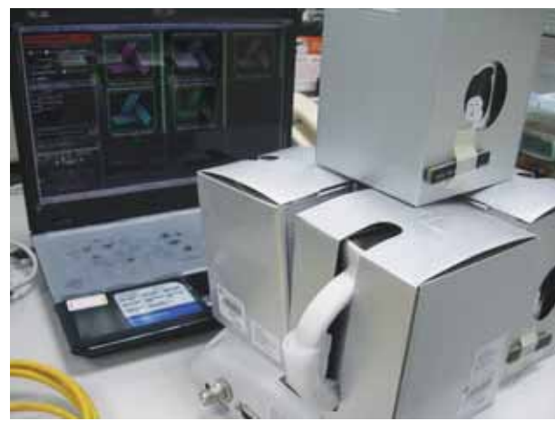
圖九 商品貼附抗金屬射頻辨識標籤測試
