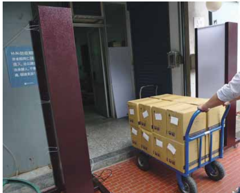
圖七 出版品門架式讀取器實地模擬測試。
