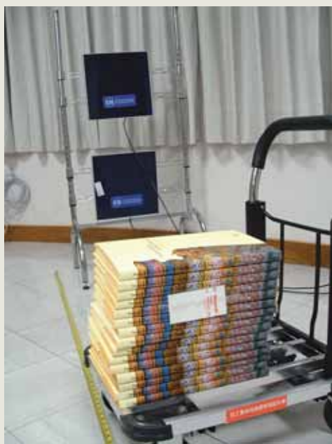
圖三 出版品測試—針對不同廠牌之門開式讀取器, 測試其讀取效果及距離範圍。
