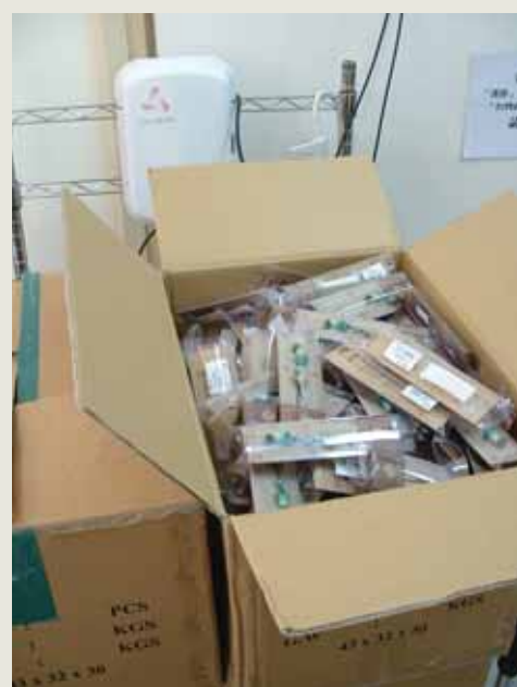
圖四 衍生性商品測試—針對不同廠牌之門開式讀取器, 測試其對於不同規格、隨意放直之讀取效果及距離範圍。
