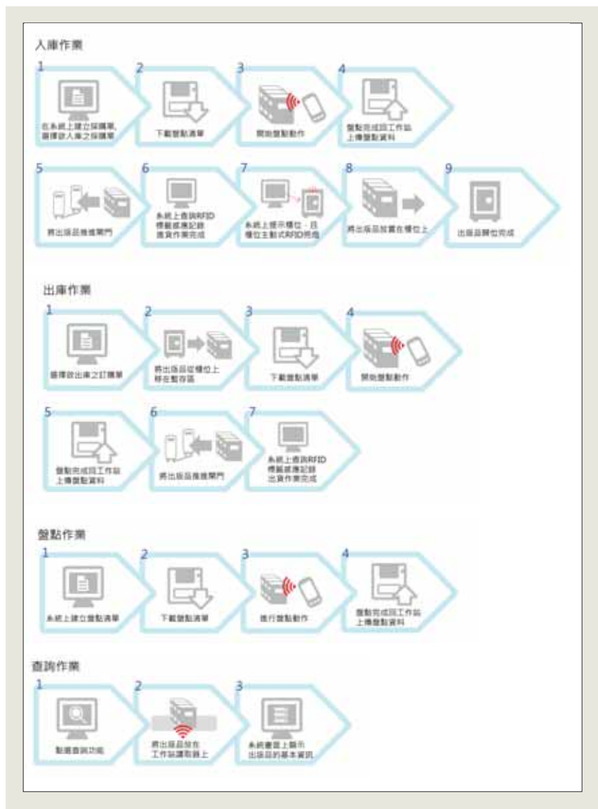
圖十 導入無線射頻辨識系統出版品借出入管理作業流程圖
