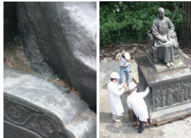
圖五 左圖為右側扶手內緣綠鏽蝕狀況，右圖為修護前攝影存檔
