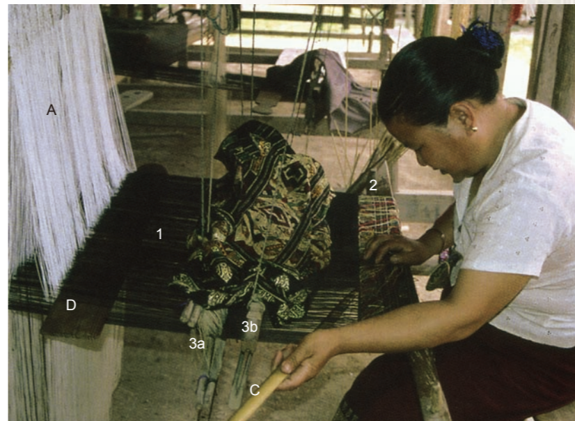
圖十一 織布中的婦女，手中持挑花棒(C)，花綜挑起的經線以輔助開口棒(D)將梭口撐開 圖片來源：Cheezman Patricia; Lao-Tai Textiles: The Textiles of Xam Nuea and Muang Phuan, p.250
