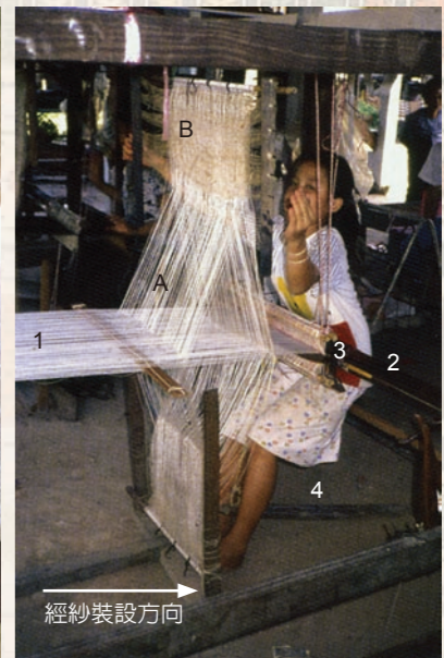
圖九 寮國織機局部，小女孩正在移動圖案棒 圖片來源：Cheezman Patricia; Lao-Tai Textiles: The Textiles of Xam Nuea and Muang Phuan, p.250 1. 經線 2. 布軸 3. 綜統片 4. 踏板 A. 花綜（一根經紗穿過一花綜） B. 圖案棒
