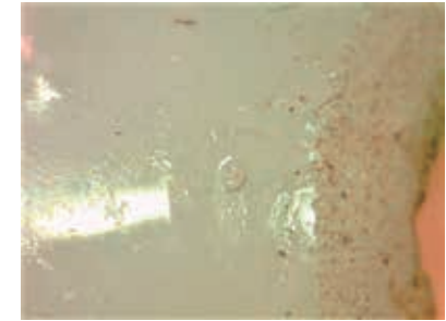
圖22-1 白色涅玻璃頂珠以手持式電子放大鏡150倍率檢視，所見內部氣泡痕跡。作者攝
