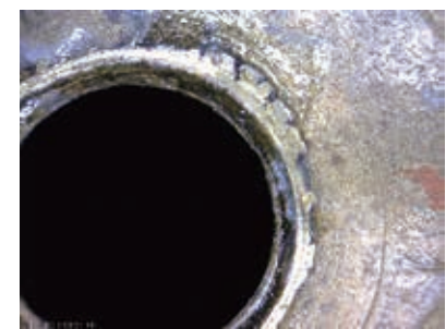
圖22-5 金屬頂珠穿孔以手持式電子放大鏡150倍率檢視，所見孔緣處穿凸的部分經過刻意打磨修飾。作者攝
