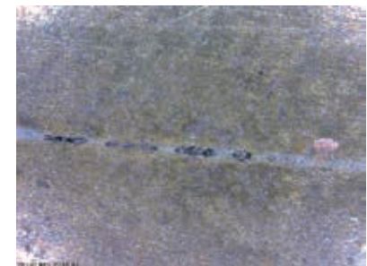
圖22-4 金屬頂珠中央以手持式電子放大鏡150倍率放大檢視，清楚可見合範線。作者攝
