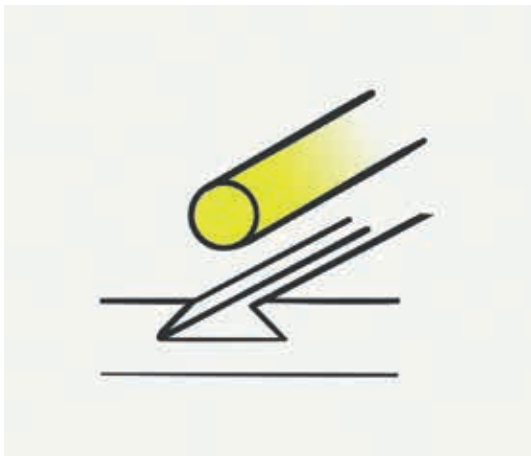
圖1 梯形槽鑲嵌示意圖 作者繪
