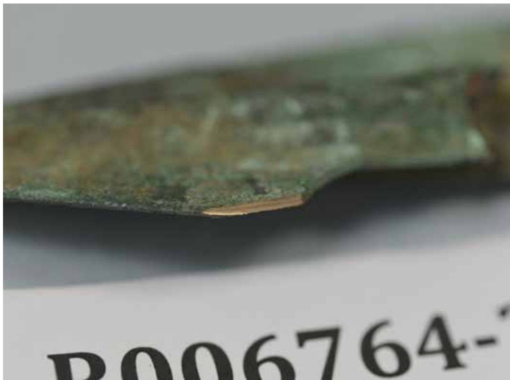
圖 3 切成小薄片時出現的殷墟青銅戈（R006764-011）剖面。青銅器表面被綠銹所覆蓋，而切斷的剖面則顯露著金屬的光澤，厚約 2 mm。
