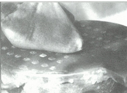
圖版七 將炭粉撒勻在公母兩範連接的鑄造面上。
