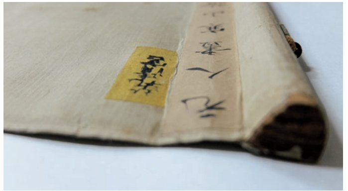
圖 13 因簽條紙材過厚，厚度差距導致簽條邊緣產生摺痕。 國立故宮博物院登錄保存處修護紀錄
