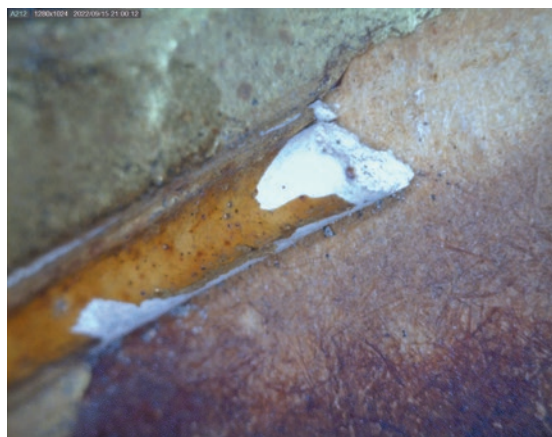
圖 6-4 以手持電子放大鏡 (Dino lite) 以 150 倍率所見館藏鳳冠紙胎表面粉線及金箔裝飾結構 作者攝
