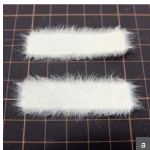
圖 6 交錯式補強的施作 a. 邊緣羽化的補強用紙 b. 邊沿交錯式的黏貼樣貌 c. 紙片黏貼固定 國立故宮博物院登錄保存處修護紀錄
